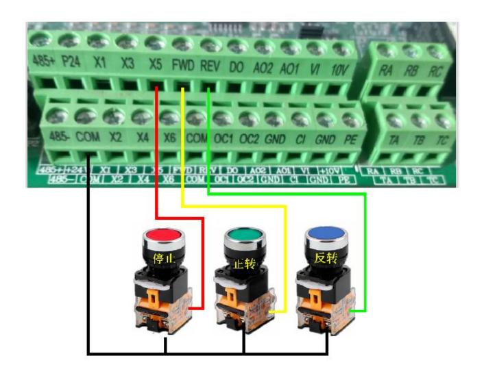
正转 FWD、COM 端子接绿色自复位按钮常开点 反转 REV、COM 端子接蓝色自复位按钮常开点
